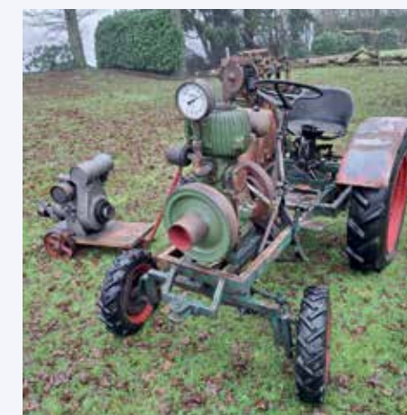
Een zelfbouwtractor met een Wolseley motor en een versnellingsbak van een Citroën 2CV.
