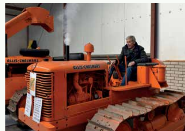
Jan startte de HD5 om te laten horen dat de 45pk sterke tweecilinder tweetakt dieselmotor met mechanische blower minder herrie maakt dan je zou denken.
