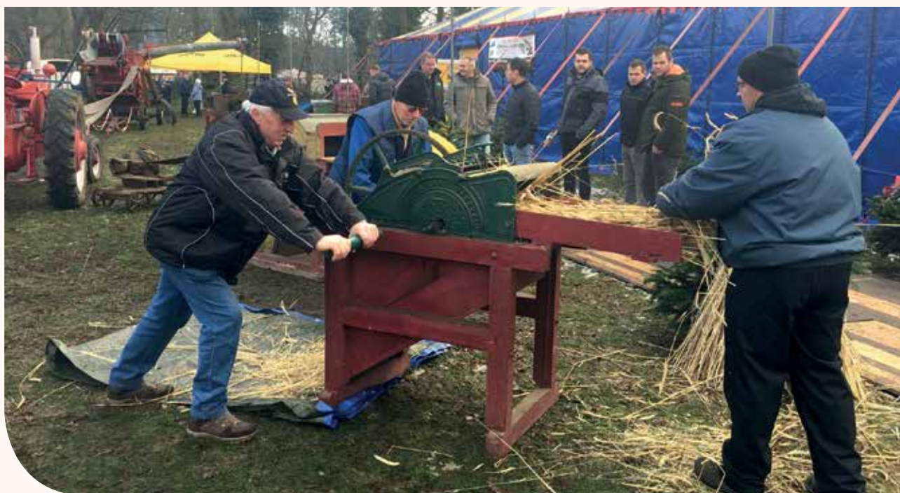
De Lanzdorstommel van Mart en Wil Snelders wordt met de hand aangedreven.
