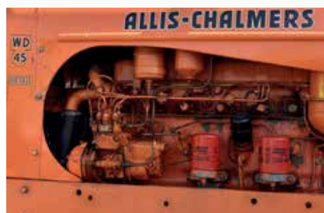
Dit is die Budamotor die volgens Jan eigenlijk te sterk was voor de WD45.
