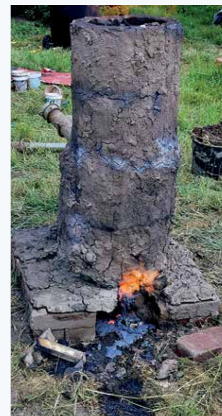
De Dalfse oven met slakkenkuil.
