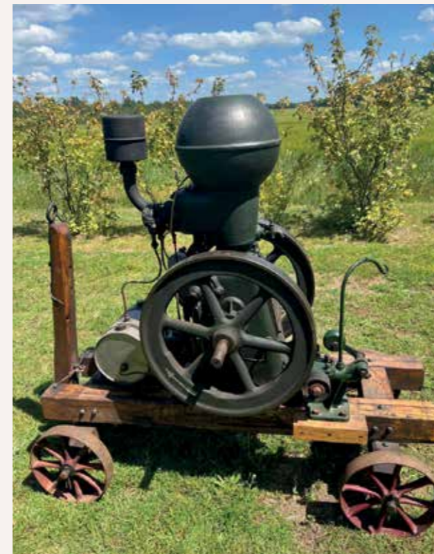
Speciaal voor de Canadese markt bouwde Lister uit Dursley Engeland deze Lister type L met een speciale bol hopper. Het voetbal grote koelwater reservoir zag er praktisch en prachtig uit. Eigenaar Martin de Bruin uit Jubbega.
