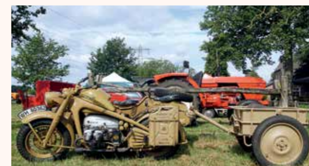
De Zündapp KS 750 motor met een Steib W.Krad_B_2 Type zijspan en aanhangwagentje.
