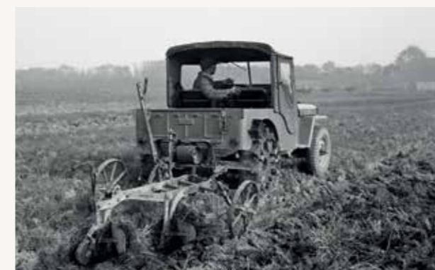
Een Jeep om te ploegen. Om de trekkracht te verhogen zijn de standaardwielen achter vervangen door speciale anti-slipwielen.
