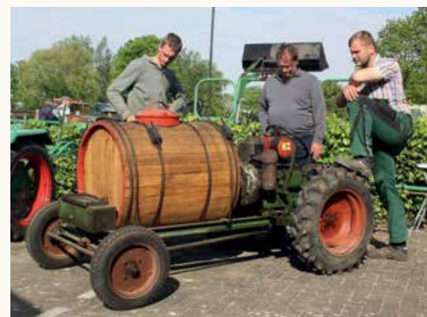
Liefhebbers bekijken de techniek van een Holder zelfrijdende spuit Auto Rekord uit 1938. JLO 360CC benzine motor met 8 PK.
