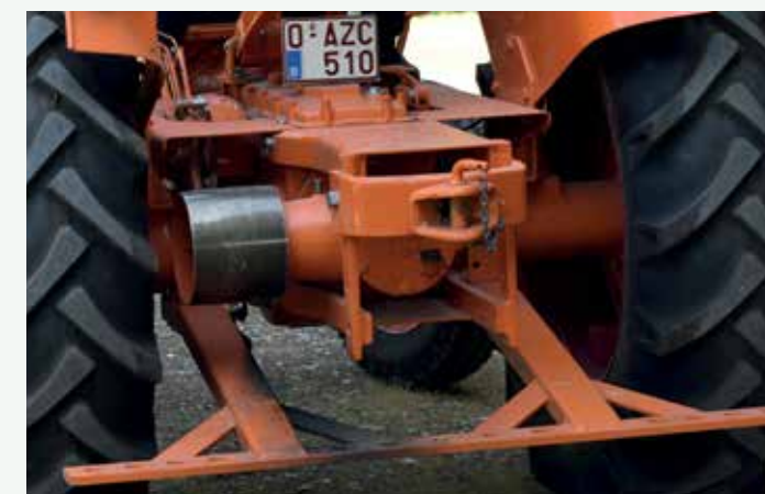
De eerste eigenaren van de A144 waren twee broers die een loonbedrijf hadden. Ze gebruikten de trekker hoofdzakelijk om mee te dorsen, vandaar de poelie en de verzwaarde achterbrug.
