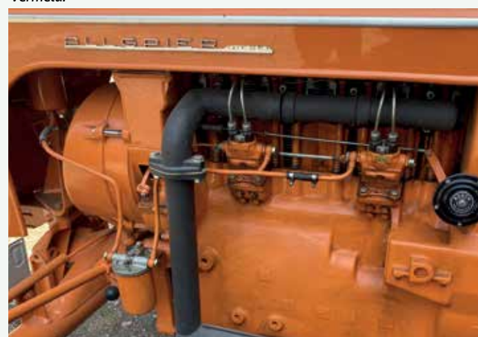
De motor van de A144 is een 4-cilinder luchtgekoelde Porschediesel van 44 pk. In de Masters 419 en 429 levert dezelfde motor 50 pk.
