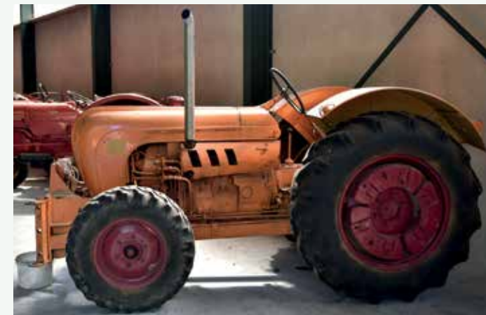
Dit is een Super 308 B in wegebouwuithoering, vandaar de B (van Baumaschine) achter de typeaanduiding.
