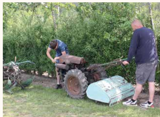
Een Holder E12 met 12PK en freesbak wordt met slinger gestart om aan de slag te gaan op het demoveld.
