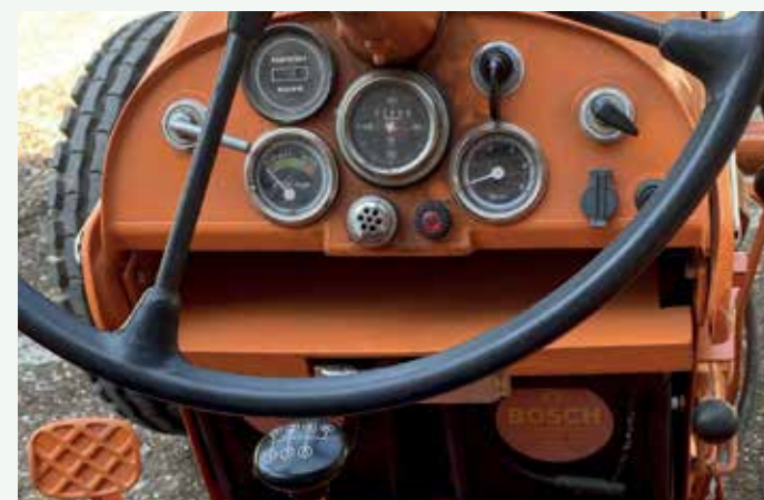
Het dashboard van de A144 en nog net zichtbaar de knop van de versnellingspook met het schakelpatroon. De K is de K van Kriechgang oftewel kruipversnelling.
