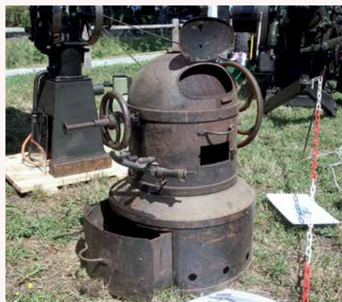
De Heinrici heteluchtmotor van Frank Vlamings die een koffiebrander aandrijft.
