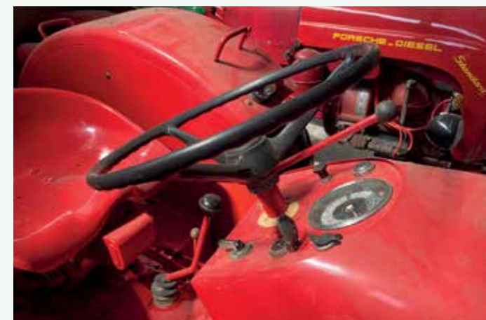
De Standard Star heeft net als de Super Export een modern dashboard dan de andere Porsches. Ook ligt het stuur een stuk platter dan van de andere modellen.
