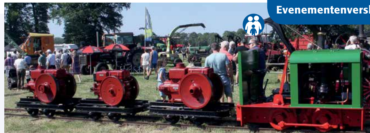
Er is een tijdelijke smalspoorweg in Saasveld aangelegd. De eigenaar van de trein met stationaire motoren is Andre Vennegoor. De locomotief is voorzien van een Deutz OME117 diesellocc met een 2-takt dieselmotor uit 1932. Deze motoren worden in de scheepvaart de 'blauwe' Deutz genoemd. Dat slaat op de blauwe walm, afkomstig van smeerolie in de uitlaatgassen. De Deutz stationaire motoren op de wagons zijn in goedlopende staat. De combinatie staat in Weerselo op een vaste opstelling en is voor één dag naar Saasveld gekomen.
