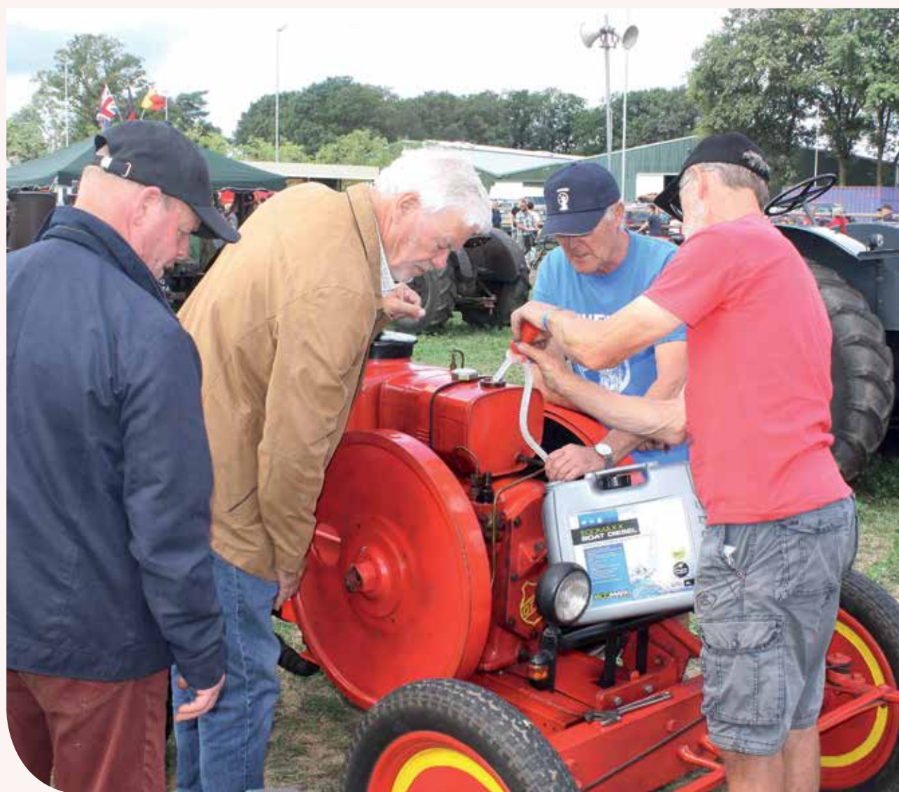
De Deutz motor heeft de hele ochtend gelopen op gas-to-liquid (GLT) brandstof. Deze heeft dezelfde samenstelling als 'e-fuel'. De plunjer van de brandstofpomp komt niet goed weer terug. Nadat de GLT brandstof is vervangen door 'gewone diesel' wordt de brandstofpomp plunjer gedemonteerd. Peter Koger (2e van links) kijkt toe.
